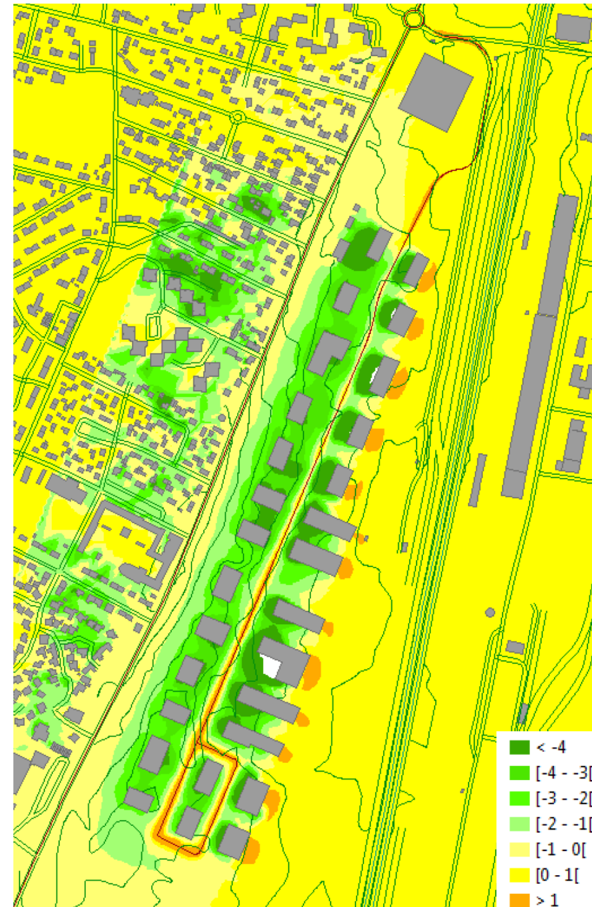
Schéma 20 : Résultat de la modélisation de l'état acoustique initial Période diurne - 6h à 22 h (IMPEDANCE)
